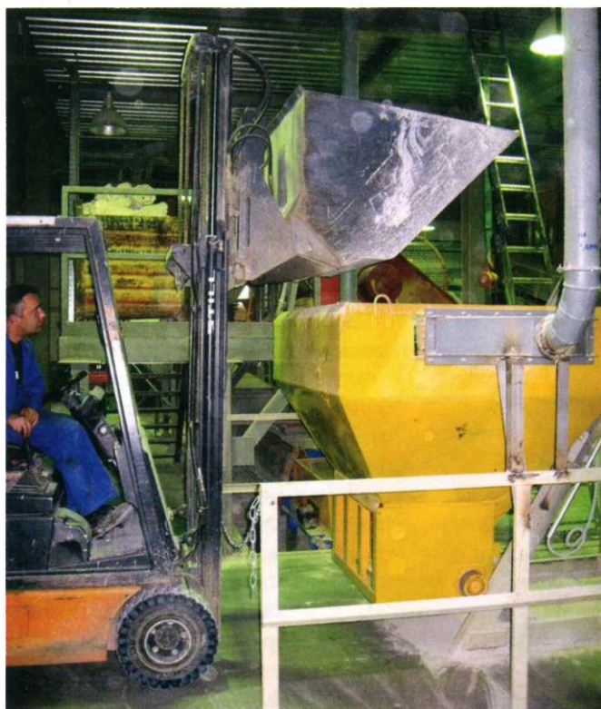
Рис. 4. Загрузка материала ковшовым погрузчиком в приемный бункер скипового подъемника
